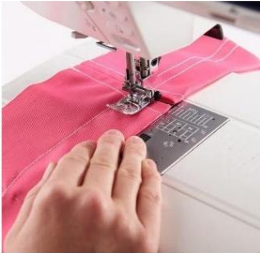
7. STEP Tunnel in die Mitte bügeln und oben im Abstand von 4 cm rundum steppen. Die zweite Steppnaht dann im Abstand von ca. 1 cm steppen
